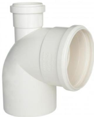
CONEXÃO UTILIZADA PARA REUNIR ESGOTOS PROVENIENTES DE DUAS DIREÇÕES DIFERENTES, FUNCIONANDO COMO JUNÇÃO. PODE AINDA SER UTILIZADA COMO PONTO DE INSPEÇÃO, BASTANDO PARA ISSO CONECTAR UM TAMPÃO (CAP) NA ENTRADA DA BOLSA DE "VISITA".
